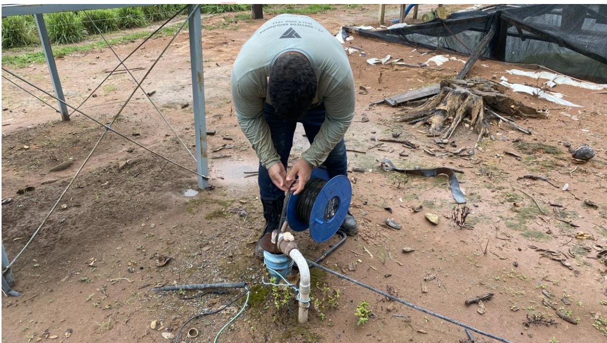
*Figura 1. Medição do N.A. em poço tubular*
