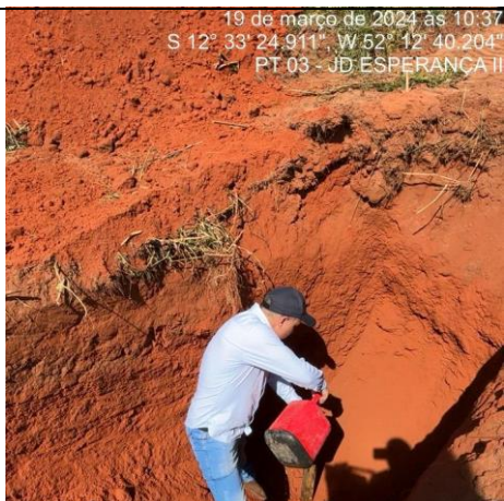
FOTO 05: Execução ensaio de permeabilidade solo.
