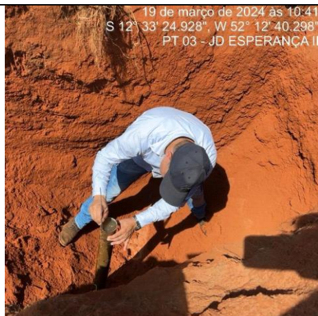
FOTO 04: Execução ensaio de permeabilidade solo..
