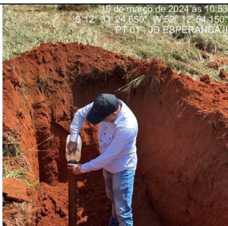
FOTO 01: Execução ensaio de permeabilidade solo.
