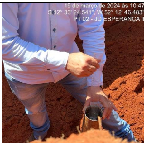
FOTO 02: Execução ensaio de permeabilidade solo.
