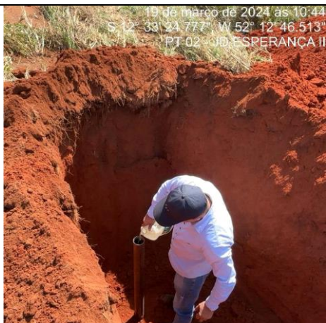
FOTO 03: Execução ensaio de permeabilidade solo.
