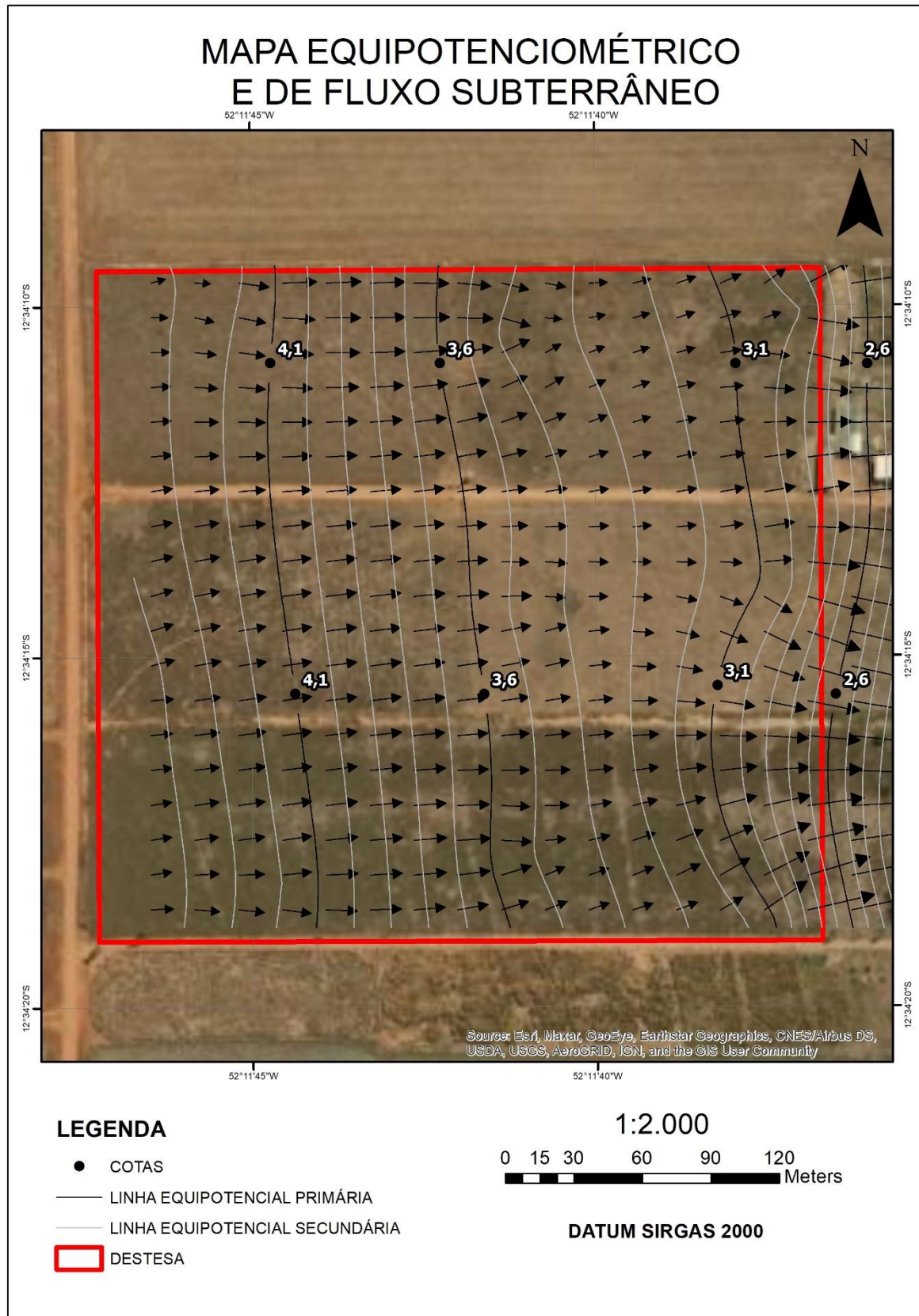
Figura 8. Mapa Equipotenciométrico e de fluxo d'água subterrânea
